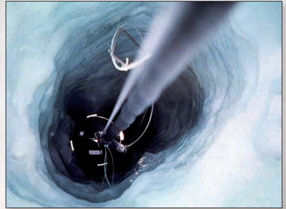
Подледная рыбалка. Ученые опускают в отверстие глубиной около 2 км в ледяном панцире Антарктиды трос с прикрепленными к нему чувствительными фотодетекторами, которые образуют нейтринный телескоп AMANDA (Antarctic Muon and Neutrino Detector Array). Земной шар служит защитным фильтром для этого телескопа, регистрирующего нейтрино, дошедшие до нас из глубин космоса.
